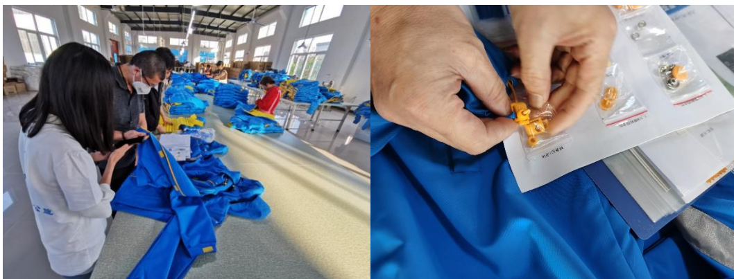
左图：壹基金工作人员与专业志愿者检验棉衣；右图：根据标准物料卡对棉衣成品进行比对
